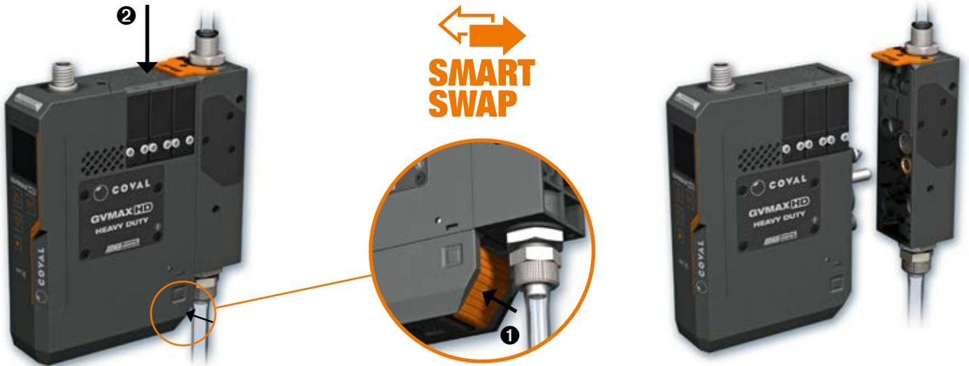
Le système de montage rapide breveté SMART SWAP COVAL permet de monter/démonter en un clin d'œil le module GVMAX HD de son embase pneumatique, sans devoir déconnecter les tuyaux d'air comprimé et de vide.
