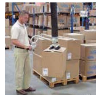
Les tubes de levage CYCLONE de COVAL Systems utilisent le même flux d'aspiration pour la prise du produit, le levage et le transfert de la charge, et constituent un système fiable et robuste.
